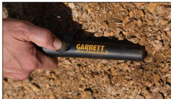
Use un proceso de encendido/apagado rápido para anular la detección de suelo mineralizado, agua salada, arena húmeda y otros ambientes desafiantes.
