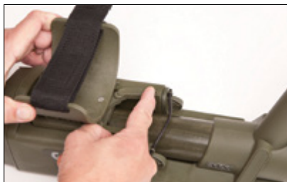
Levier de verrouillage du repose-bras illustré en position ouverte.
