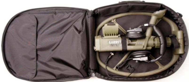
Figura 4: ATX con bobina Deepseeker acoplada + auriculares.
