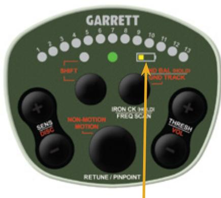
**Indicador de pilas descargadas**
