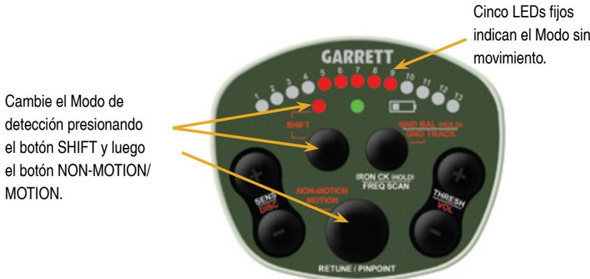
**El Modo sin movimiento** puede brindar una profundidad de detección adicional y permite que la bobina de búsqueda explore muy lentamente, incluso quieta, sobre los objetivos. El Modo sin movimiento es mejor para aislar objetivos, ya que las señales de los objetivos no producen el eco de audio que se oye en el Modo con movimiento.
