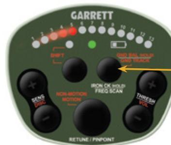
Presione y suelte FREQ SCAN mientras mantiene la bobina de búsqueda quieta y alejada de cualquier metal.
