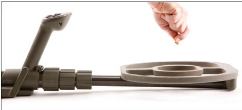
Para las pruebas preliminares, lleve el ATX afuera, lejos de interferencias eléctricas y objetos metálicos grandes. Extienda la primera varilla y coloque la bobina hacia atrás como se muestra arriba.
