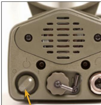
**Interruptor de encendido/apagado**
