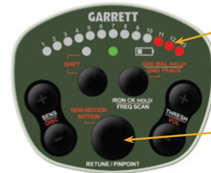
Tres LEDs rojos en el extremo derecho indican una potencia máxima de la señal del objetivo.
