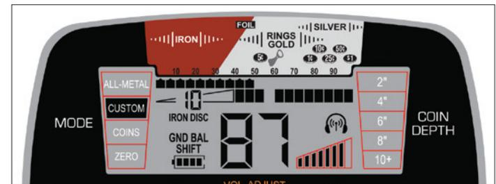
Los valores del balance de tierra arriba de 75 aumentan los cuartos de punto de la resolución. La ilustración de arriba indica un valor de balance de tierra de 87.5. Arriba del número sólido de 87, cada valor de cuarto de punto se indica por cinco bloques de pixeles en la escala superior.
