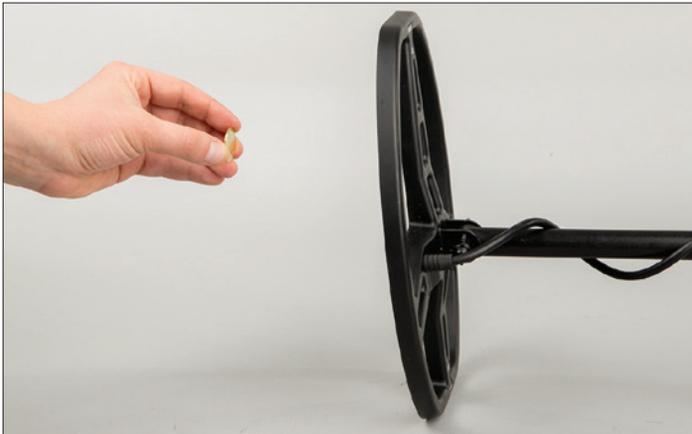
Para realizar una prueba de banco, coloque la bobina de exploración sobre una superficie plana, estable, no metálica que esté a varios pies de distancia de otros objetos metálicos.
