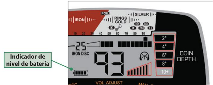
Cuatro barras indican que las baterías están completamente cargadas. Cambie las baterías cuando solo quede una barra. El detector mantendrá su desempeño total hasta que las baterías necesiten cambiarse. Pueden usarse baterías recargables de NiMH, pero pueden tener una vida útil más corta por carga. Puede esperar de 15 a 25 horas de operación sin audífonos inalámbricos y de 10 a 20 con audífonos inalámbricos, dependiendo del tipo y calidad de la batería.
