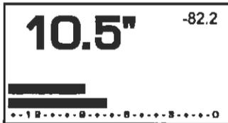
La fase D.C. del terreno tiene una relación con el ajuste propio del balance del terreno. Este es de interés particular para aquellos que usan la opción gruesa (COARSE) o fina (FINE) de la opción del balance manual del terreno (GEB).
