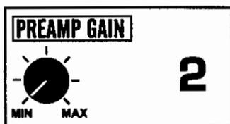
**PISTA-** LOS NIVELS ALTOS INCREMENTAN LA DETECCION DE LA PROFUNDIDAD SIN EM-BARGO. EL DETECTOR DEBE ESTAR ESTABLE PARA SER CAPAZ DE RECONOCER UN BLANCO, LA SOBRECARGA (OVERLOAD) DEBERIA DE NO APARECER EN LA PANTALLA CUANDO ESTAN PRESENTES SOLAMENTE MINERALES EN EL TERRENO. LOS AJUSTES DISPONIBLES SON DESDE 1 HASTA 4.
