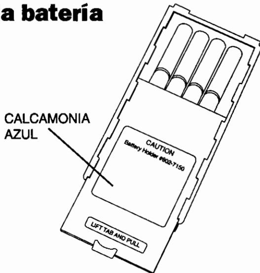
1. El contenedor estandar de las baterías (azul decal) mantiene ocho baterías de celda "doble A". Las baterías alcalinas son recomendadas para ser usadas con este contenedor.
