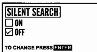
El ajuste se muestra con una selección de Encendido/ Apagado el cual necesita sólo presionar ENTER para cambiar el ajuste. Presione ENTER de nuevo para cambiar al ajuste original.
